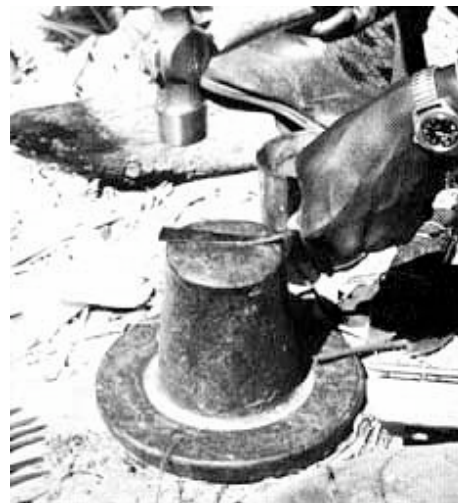
19. A végleges formát nyert billentyűt meghajlítja a lapátvég és a farok találkozásánál
